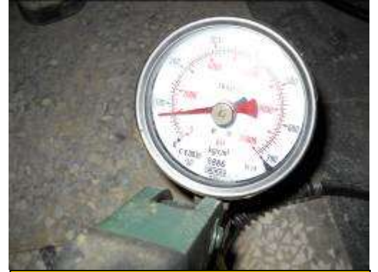
植筋拉拔試驗
