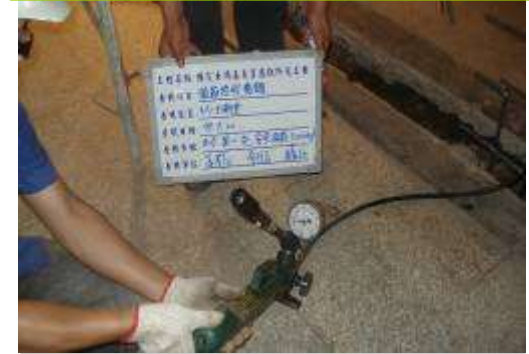
植筋拉拔試驗
